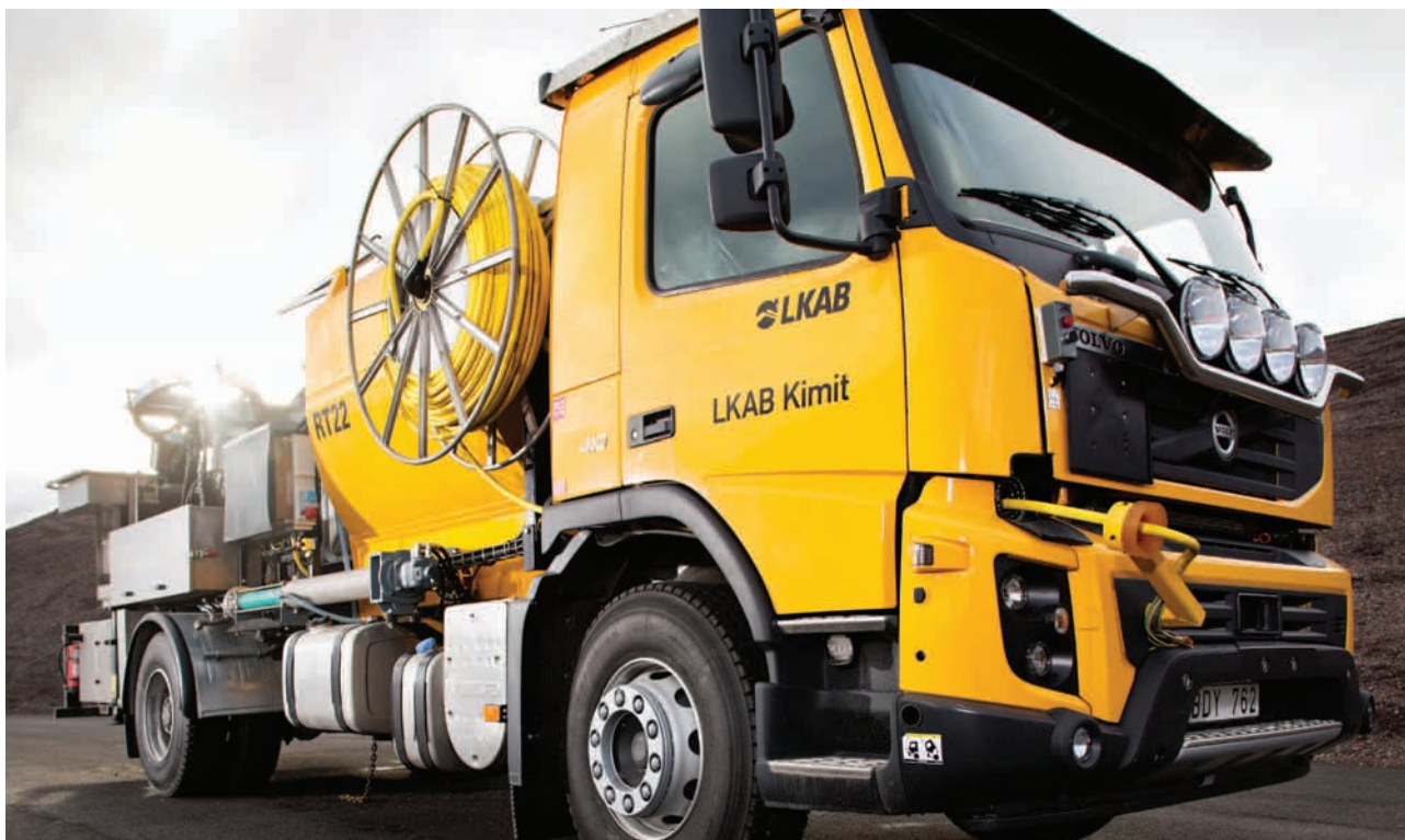
Laddfordon för tunnelladdning
